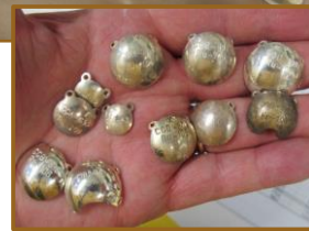
Abb.: ^{106}\text{Ru} Augen-Applikatoren für Tumor-Behandlung (HWZ 372 d)
