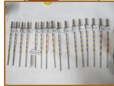
Abb.: ^{68}\text{Ge}/^{68}\text{Ga} -Kalibrierstäbe ( ^{68}\text{Ge} HWZ 271 d)
