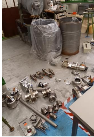
Abb.: Beschleuniger 3MV Van-Graaff - Tritium kontaminierter Beschleunigerrohre und Teile
