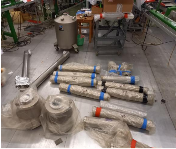
Abb.: Beschleuniger 3MV Van-Graaff - Tritium kontaminierter Beschleunigerrohre und Teile
