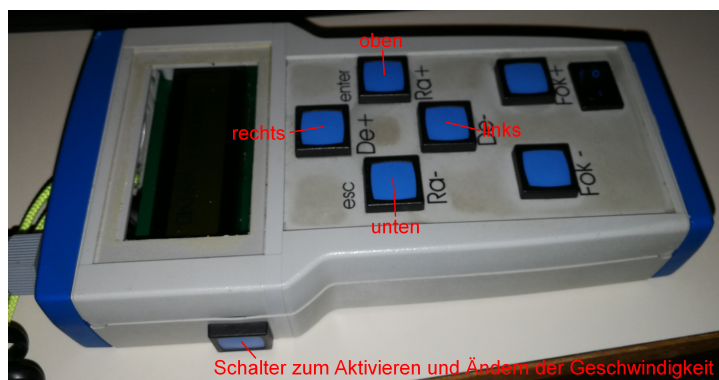
Abbildung 1: Anordnung der Handbox zum Zentrieren eines Objekts in einer Aufnahme.
