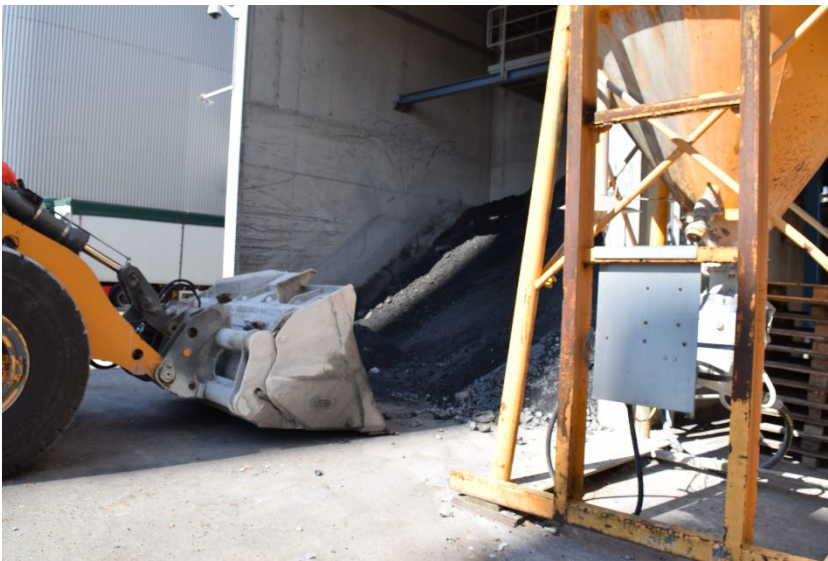
Verladen von Rostasche am Heizkraftwerk. Die in der Studie untersuchten Proben wurden nach gängigen Richtlinien an der Anlage entnommen. Foto: Johanna Eichermüller/Hochschule für Forstwirtschaft Rottenburg
