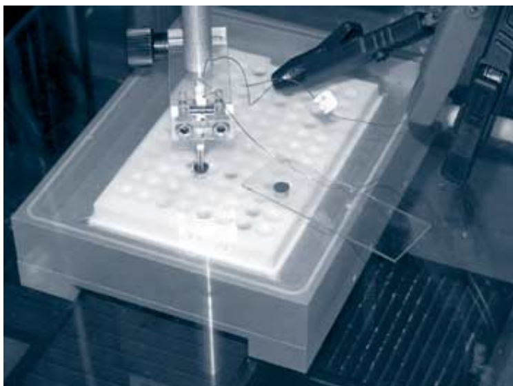
Der Arm des elektrochemischen Rastermikroskops arbeitet sich zügig von einem winzigen Reaktionsgefäß zum nächsten vor. So können zahlreiche verschiedene Reaktionen in kurzer Zeit durchgeführt werden. Foto: Haas
