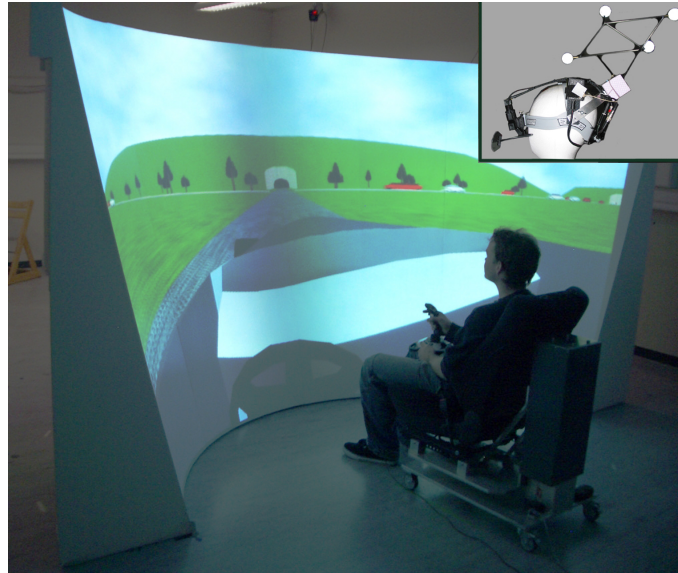
Abbildung 2.7: Um die Dimensionen abschätzen zu können wird hier ein Photo der Leinwand gezeigt. Der Proband sitzt auf einem höhenverstellbaren Stuhl, so dass sich seine Kopf über dem Zentrum des Kegelstumpfsegments befindet und die Augenhöhe 1,2m beträgt (vgl. Abbildung 2.6). Rechts oben wird ist der Eyetracker mit Headtracking-Target zu sehen (s. Kapitel 2.3.1 bzw. 2.3.2)
