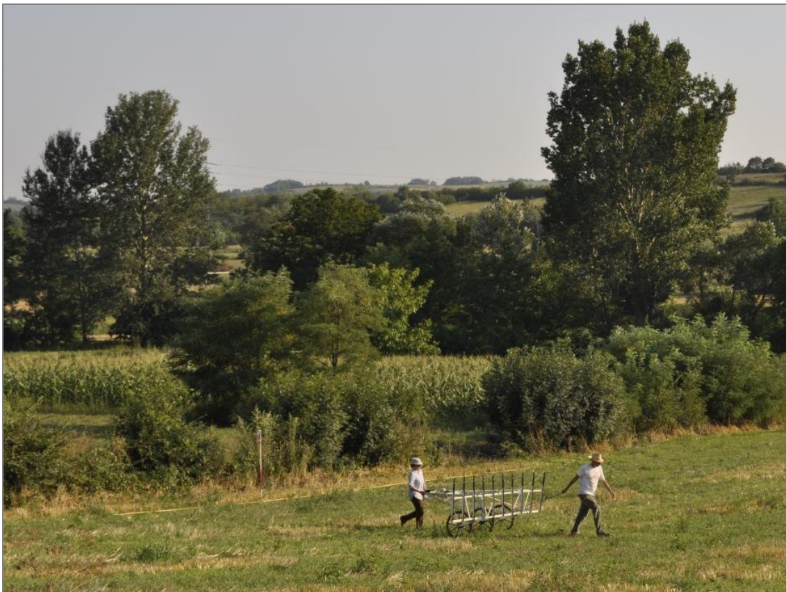
Abbildung I227-2: Zehnkanales magnetisches Messsystem MAG-DRIVE mit Digitiser LEA D2 im Einsatz auf der Fundstelle Belica (Foto: R. Krauß)
