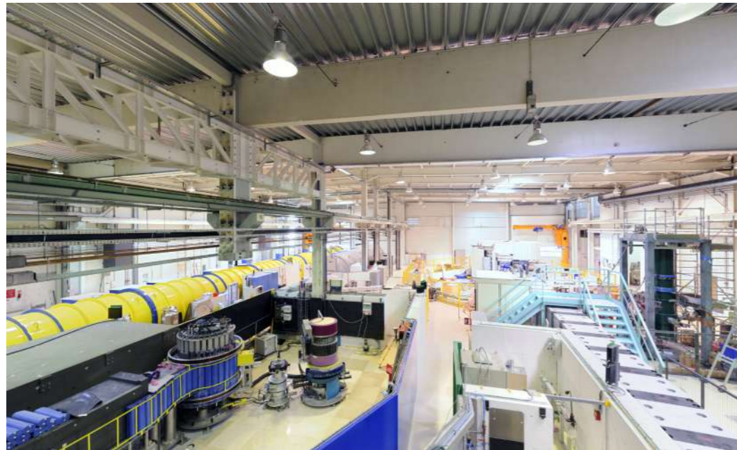
Blick auf eine der Leiterhallen des ILL. Hier befinden sich die Neutronenleiter, die die Neutronen zu den Experimenten bringen und die Instrumente an denen die Experimente durchgeführt werden.
