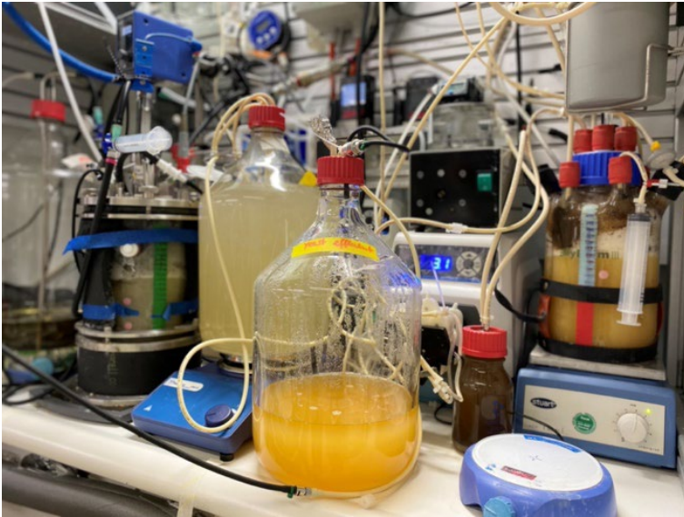
Zweistufiges Bioreaktor-System, in dem mit Proteinen und dem Vitamin B 9 angereicherte Hefe produziert wird. Foto: Lisa Marie Schmitz
