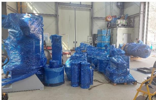
gekennzeichnet werden, damit später eine Nachbesserung vorgenommen werden konnte. Aufgrund der unterschiedlichen Beschaffenheiten der Maschinen mussten diese vor der Lieferung an den Auftraggeber mit spezieller Schutzfolie eingewickelt werden. Bei dieser Gelegenheit lernte
