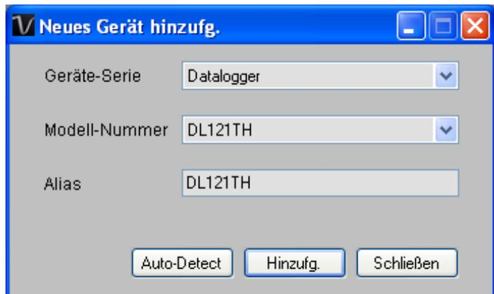
Nach dem Bestätigen des neu entdeckten Geräts muss es unter der richtigen Serie und Nummer hinzugefügt werden.
