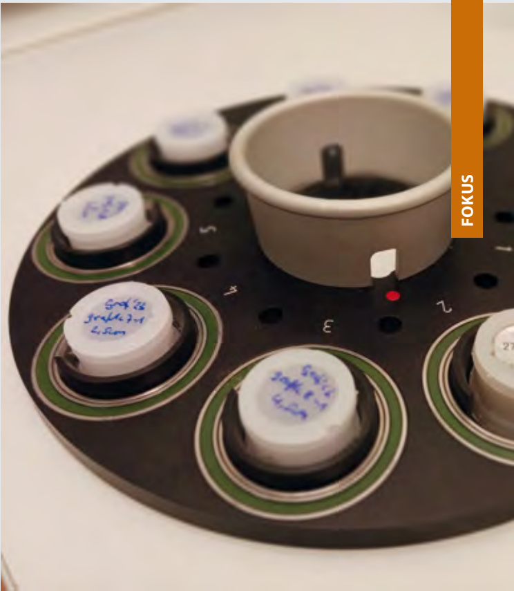
VORBEREITUNG VON SEDIMENTPROBEN für XRF-Analysen chemischer Parameter im Labor der RGK, Frankfurt. Foto: L. Werther, DAI-RGK
