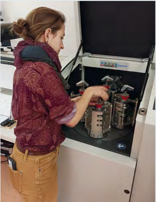
VORBEREITUNG VON SEDIMENTPROBEN für XRF-Analysen chemischer Parameter im Labor der RGK, Frankfurt. Foto: L. Werther, DAI-RGK
