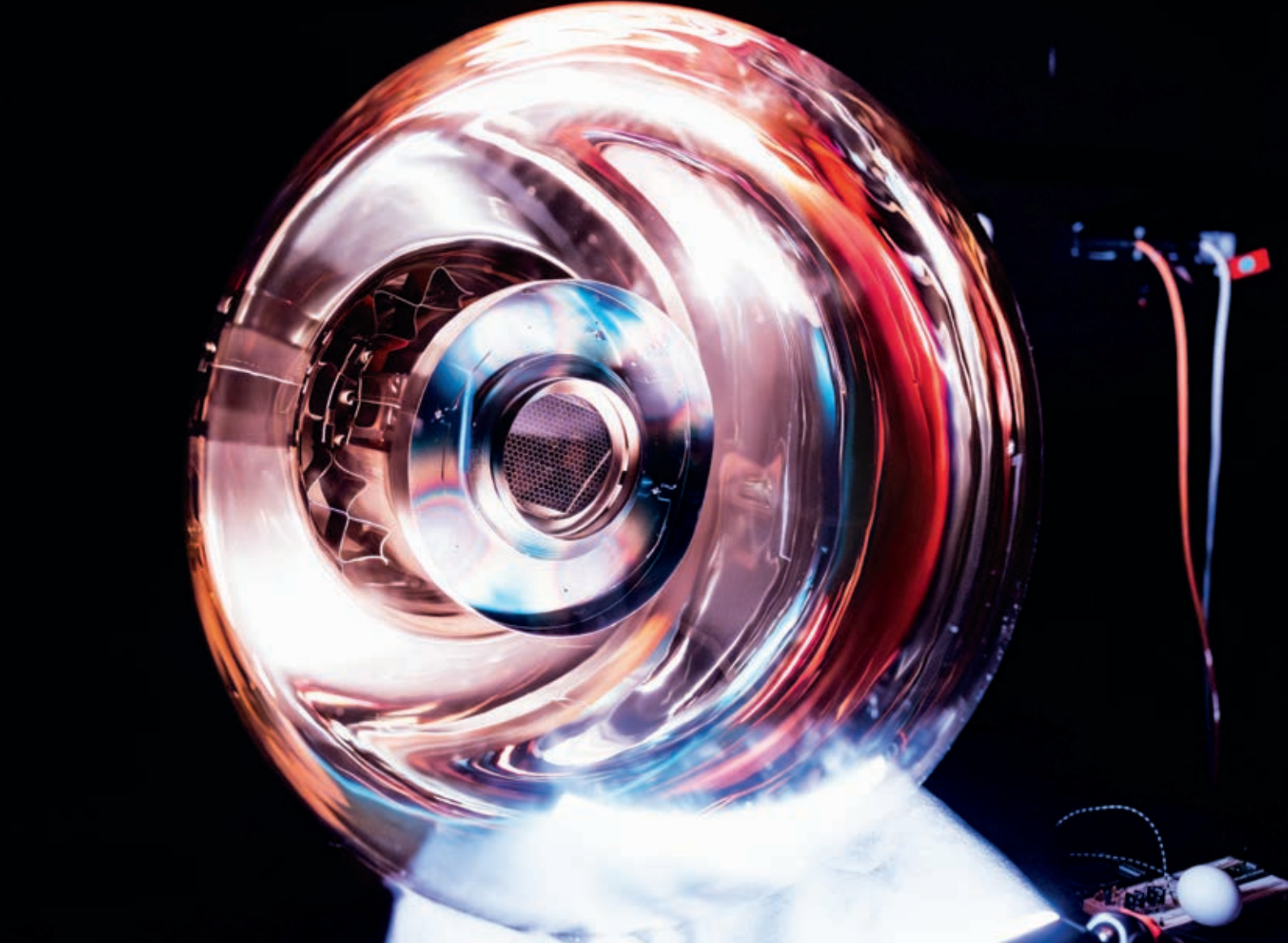
Ein Photomultiplier wie die 17.000 im JUNO-Detektor: Das Tübinger Labor übernahm die Qualitätsprüfung per Fernmessung.
