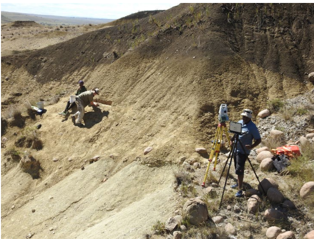
Archologische Ausgrabungen an der Fundstelle Jojosi 6 im Jahr 2024. Die Person am Tachymeter dokumentiert die genaue rumliche Position aller gefundenen Artefakte in 3D mit einem Laser. Foto: Universitt Tbingen / Manuel Will
