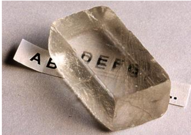
Abb. 2.24: Doppelbrechung beim Calcit.
