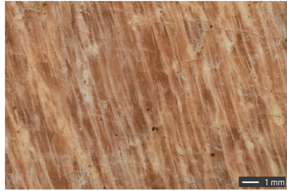
Abb. 2.5: Perthitische Entmischtextur in Alkalifeldspat.
