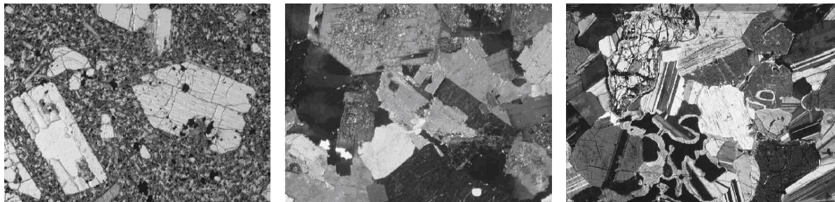
Abb. 1.3: Idiomorphes (links), hypidiomorphes (mitte) und xenomorphes (rechts) Gefüge.
