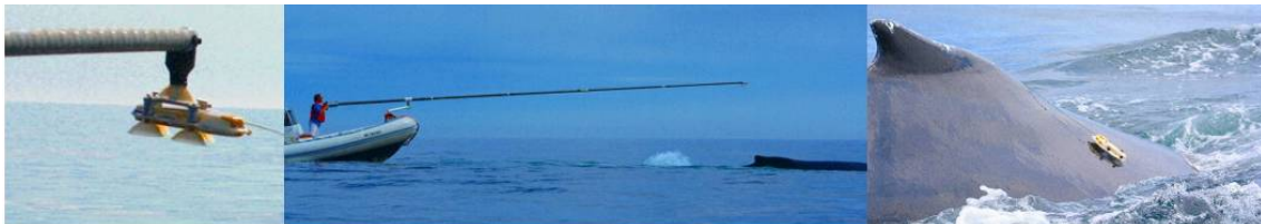
Abbildung 2.2: Beobachtung von Walen mittels DTAG. links: Digital Accoustic Recording Tag (DTAG), Mitte: Verfolgung eines Wals zur Anbringung des DTAGs, rechts: DTAG mittels Saugnäpfen an Wal befestigt [JT03]
