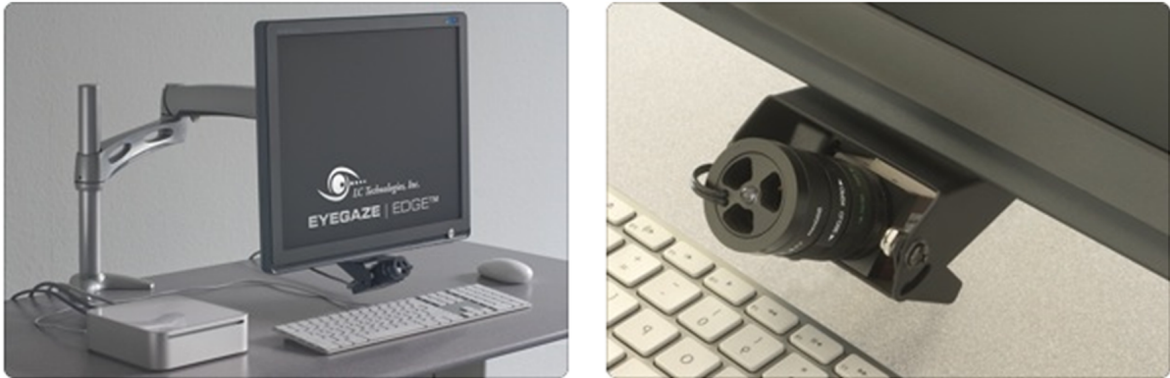
Abbildung 2.1: Augen-Tracker vom Modell EyeGaze [Quelle: Interactive Minds]
