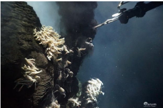
Bei den Feldstudien an Schwarzen Rauchern kommen Tauchroboter in bis zu 3000 Meter Wassertiefe zum Einsatz, welche mit umfangreicher Sensorik ausgestattet sind und Proben der Fluide und Gesteine bergen. Fotos: MARUM – Zentrum für Marine Umweltwissenschaften, Universität Bremen.
