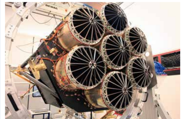
Spiegelmodule für eROSITA: In jedem befindet sich eine eigens entwickelte, hochempfindliche Röntgenkamera. // Mirror modules for eROSITA: Each contains a specially developed, highly sensitive X-ray camera.
